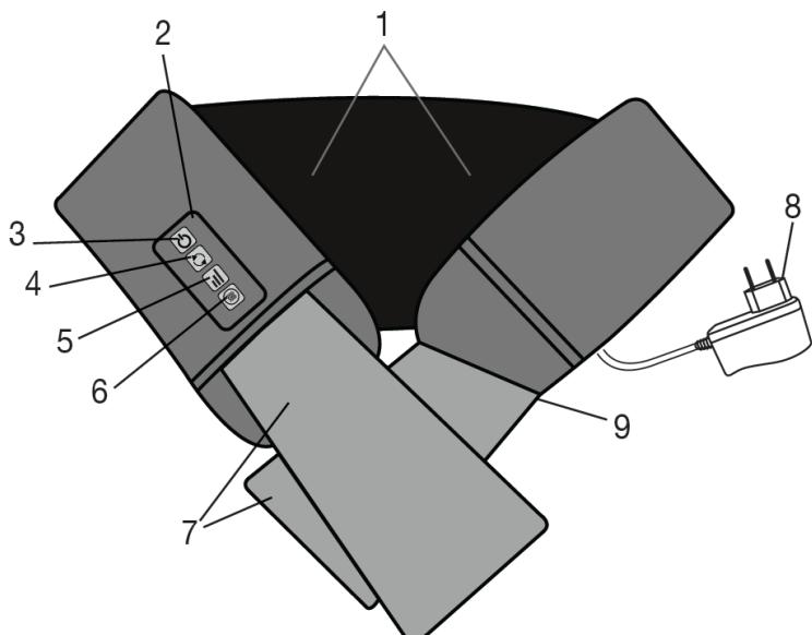
1. 16x Teste massaggianti (8 teste massaggianti riscaldate e illuminate), rotanti a coppia
